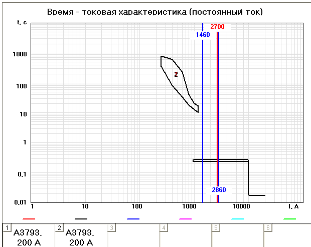
Рис. 20. Карта селективности защитных аппаратов: вводного №1 (А3793, 630А (200/16с/1200/0,25с)) и аппарата №2 распределительной линии (А3793, 630А (200/16с/1200/0,25с)). Селективность аппаратов защиты 1-ой и 2-ой ступеней не выполняется из-за полного перекрытия их времятоковых характеристик (аппараты сработают одновременно).
